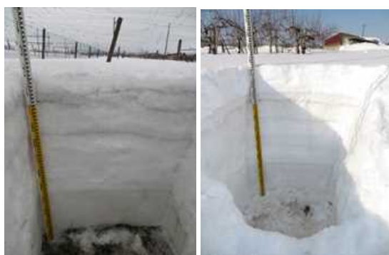
散布区 無散布区 図2 2月1日の積雪断面 (散布区は炭の層が明瞭)
