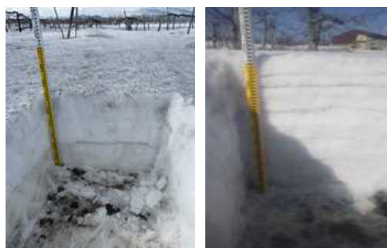
散布区 無散布区 図3 3月15日の積雪断面 (散布区は積雪面が黒く変色)
